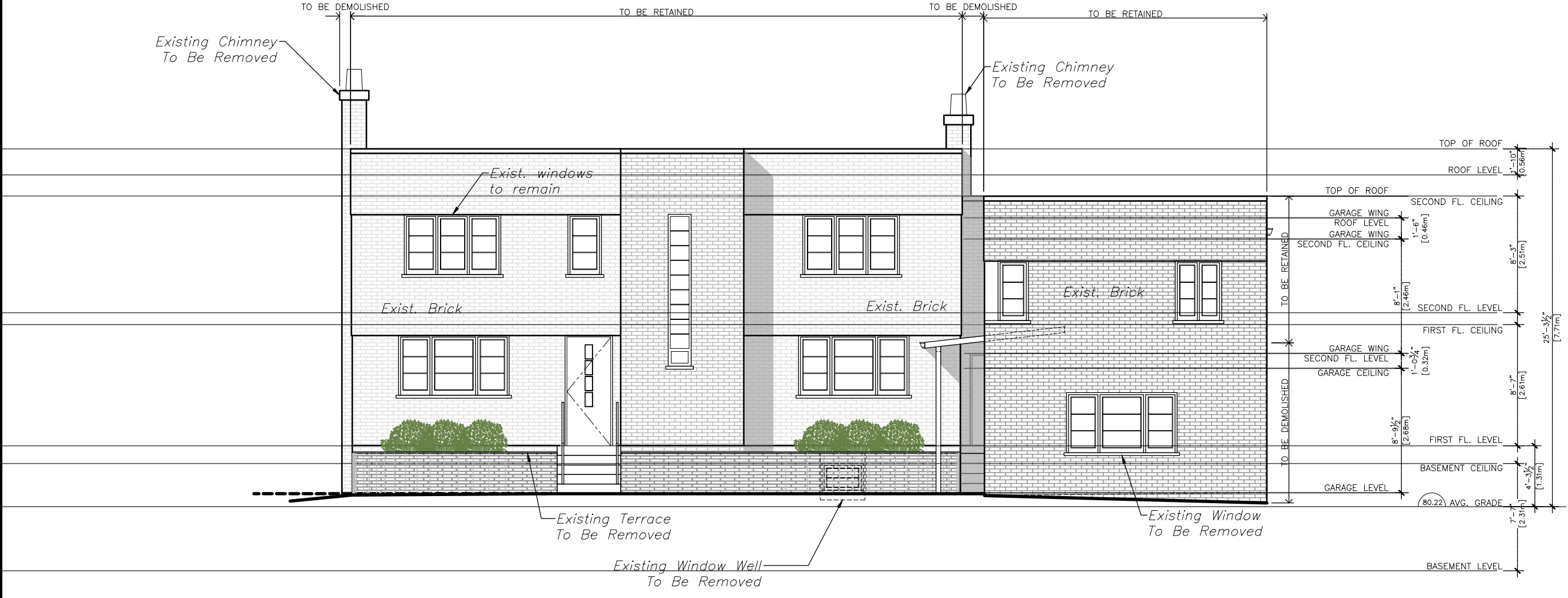
1 NORTH ELEVATION - EXISTING A1.2 Scale: 1/8" = 1'-0"
